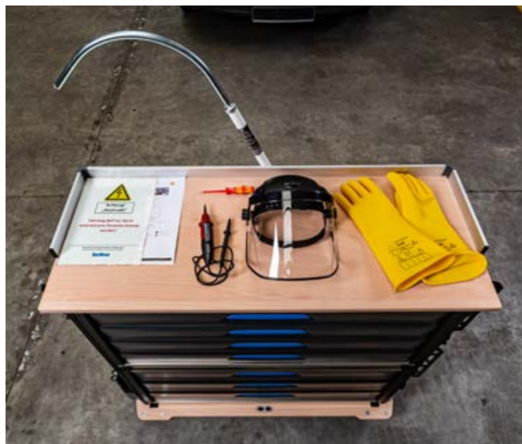
Mobil arbejdsplads med høj spænding
